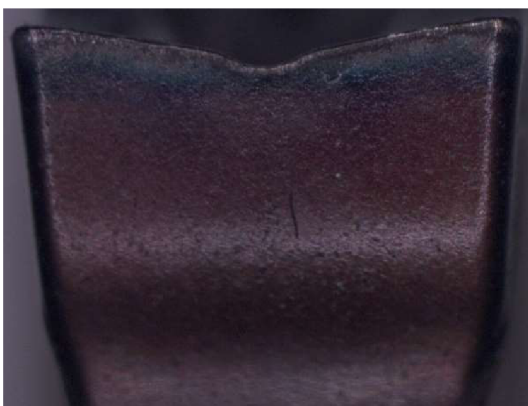
Obr. 71 Destička C2 po 15,3 minutách (HH). Obr. 72 Destička C2 po 30,6 minutách (HH).
