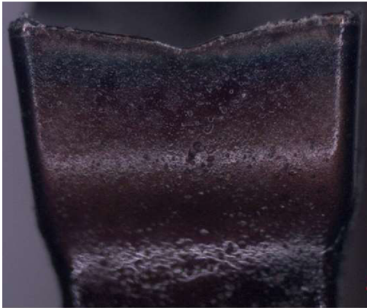
Obr. 68 Destička C1 po 25,5 minutách (HH). Obr. 69 Destička C1 po 25,5 minutách (VH).
