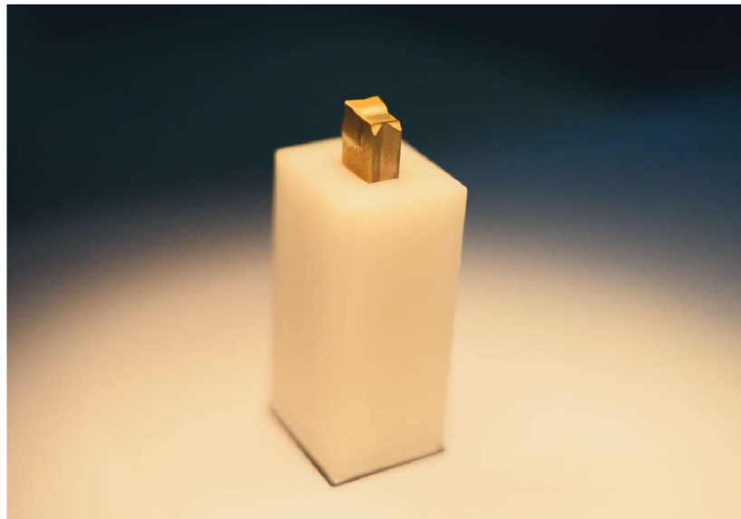
Obr. 23 Hotový přípravek s VBD pod mikroskopem.
