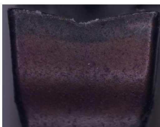
Obr. 71 Destička C2 po 15,3 minutách (HH). Obr. 72 Destička C2 po 30,6 minutách (HH).
