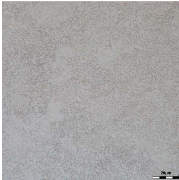
Obr. 84 Snímek mikrostruktury (mat. ČSN 14 109, vzorek 2).
