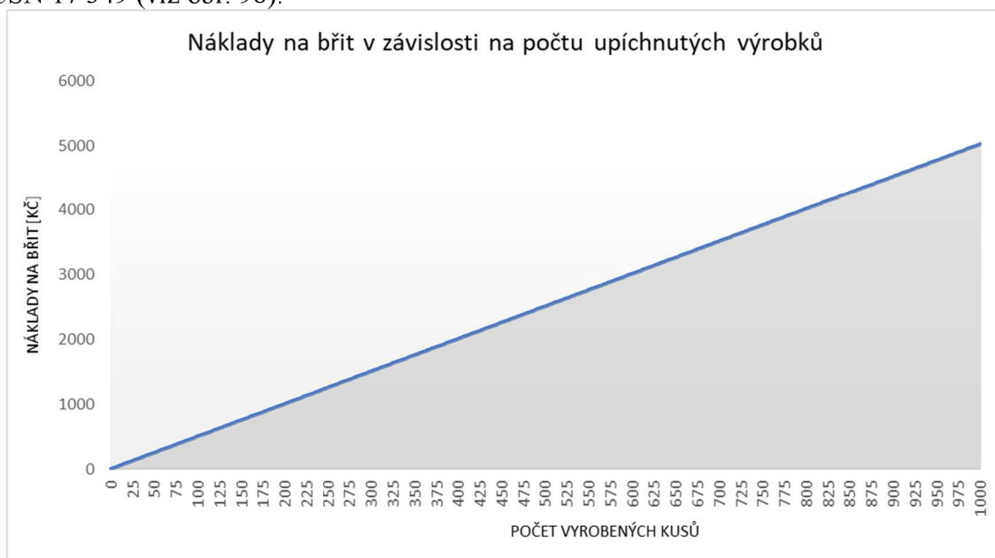
Obr. 97 Náklady na břit v závislosti na počtu upíchnutých výrobků (destička A, mat. ČSN 14 109).
