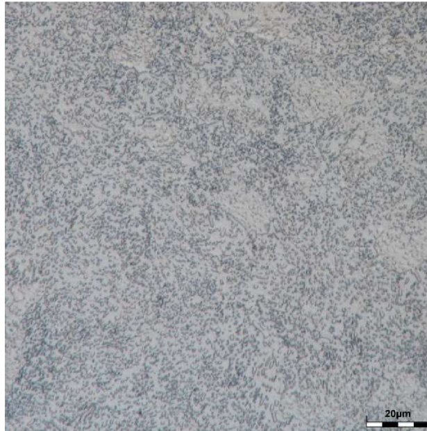
Obr. 83 Snímek mikrostruktury (mat. ČSN 14 109, vzorek 1).
