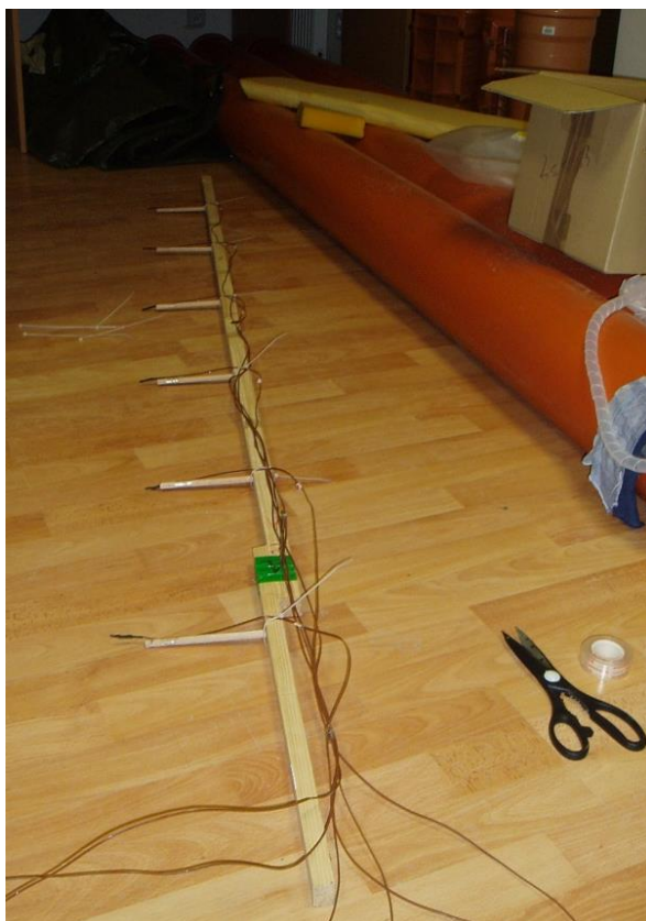
Obr. 6.6: Příprava zemní sondy „A“ pro měření teplot v zemině (v oblasti ovlivněné ZVT); foto: autor
