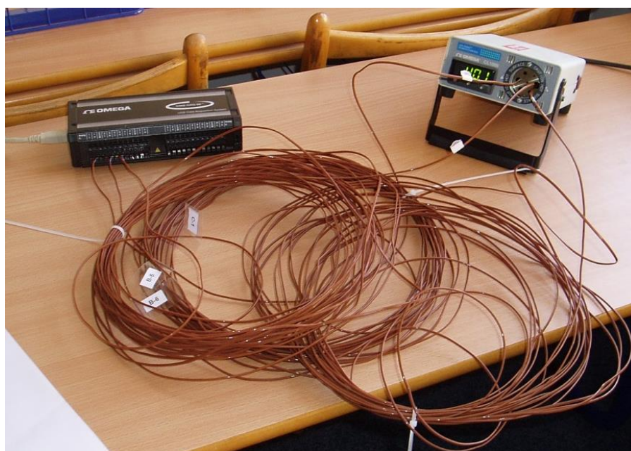
Obr. 6.5: Kalibrace termočlávků pro měření teploty v zemině – foto: autor
