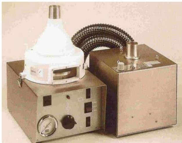
Obr. 4.4: Štěrbínový vzorkovač pro odběr vzduchu (Casella/UK) – převzato z [163]
