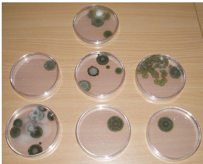
Obr. 7.10: Zkouška různých dob expozice pro záchyt bioaerosolu z vnitřního prostředí budovy – CZD agar
