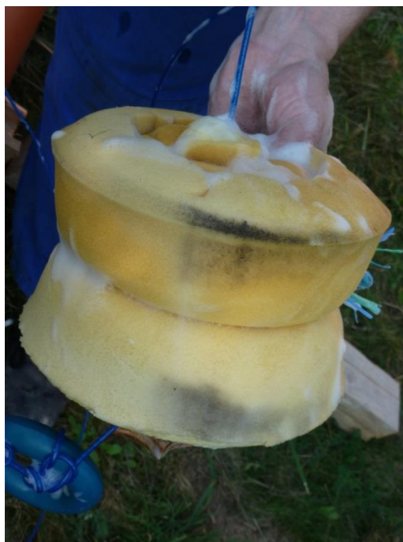
Obr. 6.11: Molitanový přípravek na čištění potrubí; foto: autor
