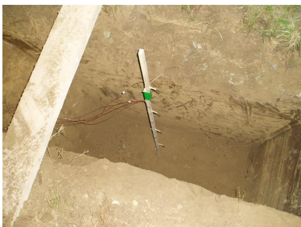
Obr. 6.18: Instalace zemní sondy „D“ (nahore); foto: autor
