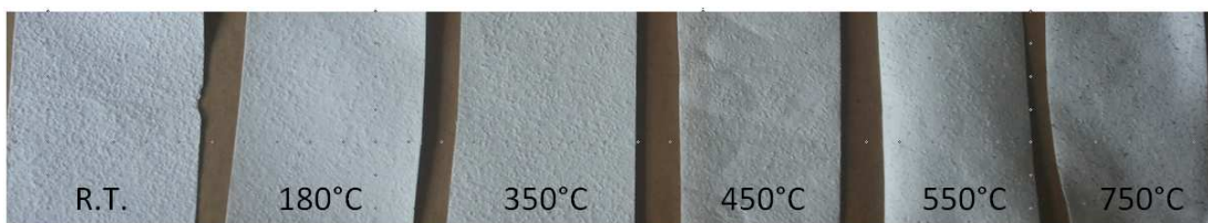
Obr. 35 Vizualní hodnocení vlivu tepelné stabilizace na barvu a makroskopický vzhled křemičitých nanovláken.
