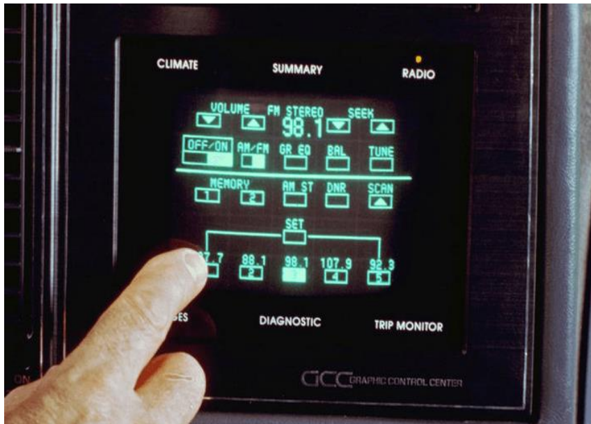
Obr. č. 15_První dotykový displej u Buick Riviera (TheTurnSignalBlog 2021)
