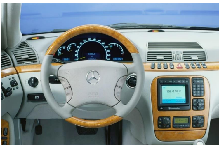
Obr. č. 6 První multifunkční volant automobilky Mercedes-Benz na modelu S-Class W220 (Mercedes-Benz 1998)
