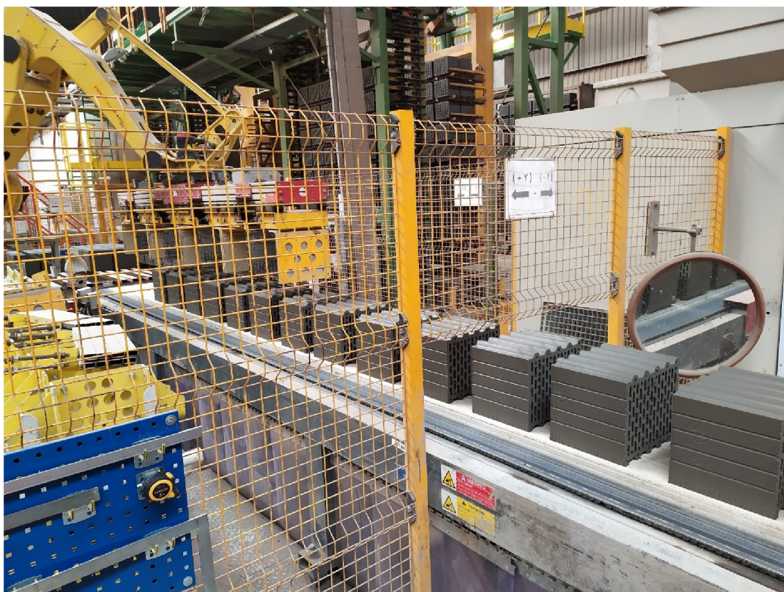
Obr. 4.4 Přesouvání cihel robotem
