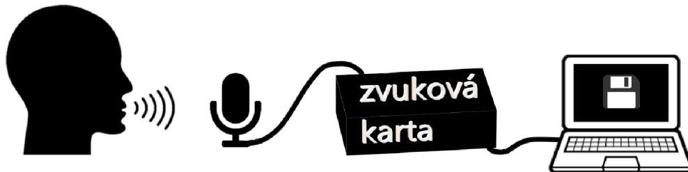
Obrázek 4.4: Řeč je zachycena mikrofony, zpracována zvukovou kartou a uložena na laptopu.
