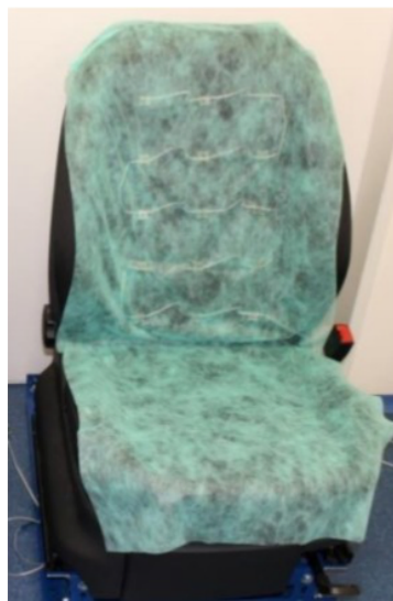
Obr. 17: Meracia podložka na autosedadle [29]
