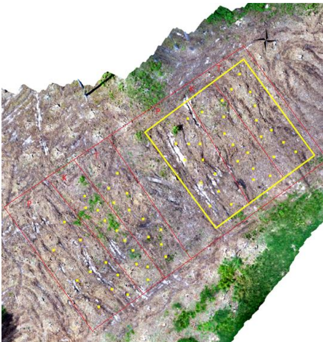
Příloha 5: Kalamitní holina 711 H 0. Schéma rozvržení variant přípravy půdy (T - talířová fréza; K - kontrolní bez přípravy půdy; P - pluh) a rozmístění zkusných plošek (žluté body), oplocenka (značeno žlutým ohraničením) zdroj: Pracovní materiál katedry Hospodářské úpravy lesů, Fakulta lesnická a dřevařská, Česká zemědělská univerzita v Praze.
