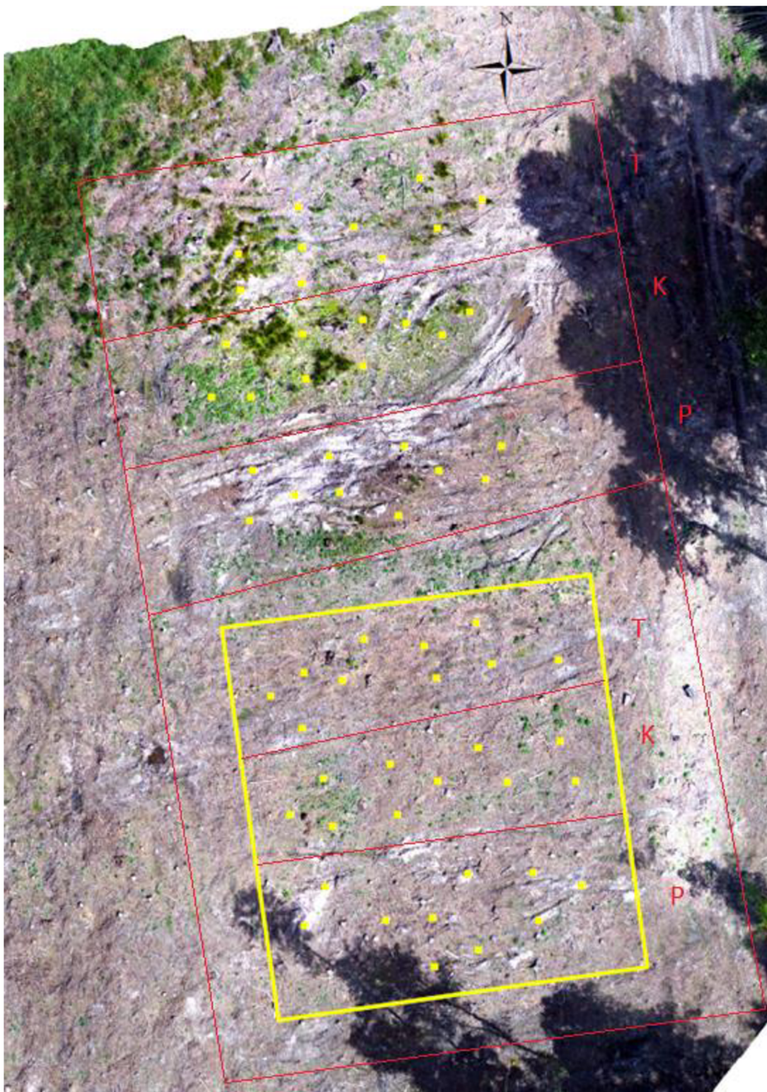
Příloha 4: Kalamitní holina 711 A 0. Schéma rozvržení variant přípravy půdy (T - talířová fréza; K - kontrolní bez přípravy půdy; P - pluh) a rozmístění zkušných plošek (žluté body), oplocenka (značeno žlutým ohraničením) zdroj: Pracovní materiál katedry Hospodářské úpravy lesů, Fakulta lesnická a dřevařská, Česká zemědělská univerzita v Praze.
