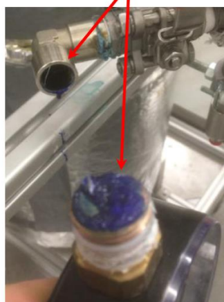
Obrázek 44 – Vznik nánosů během experimentu na vedlejší větvi dopravní trasy s manometrem.
