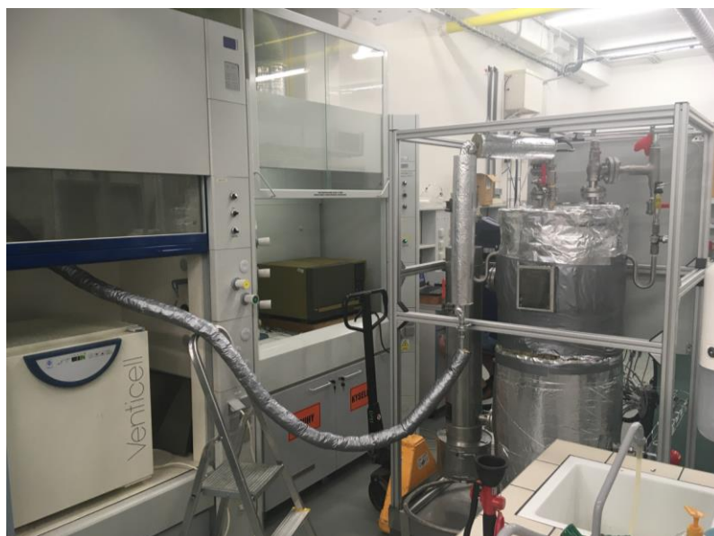
Obrázek 42 – HGA při prvním testu s odvodem vyráběné páry do digestoře.
