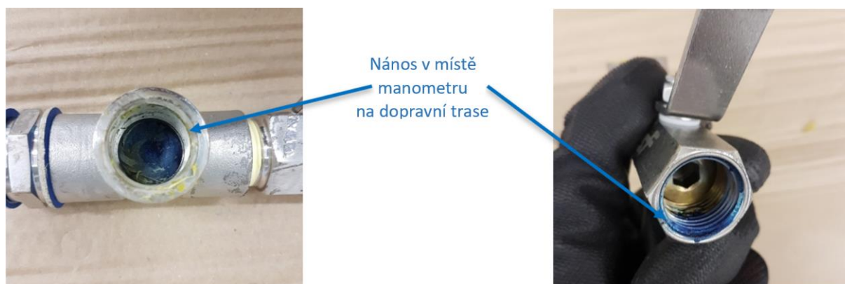
Obrázek 48 – Nános v nedostatečně vyhřívané odbočce na dopravní trase plynu z HGA.
