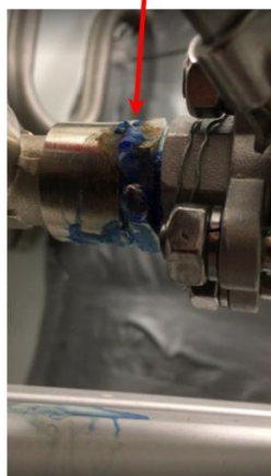
Obrázek 44 – Vznik nánosů během experimentu na vedlejší větvi dopravní trasy s manometrem.
