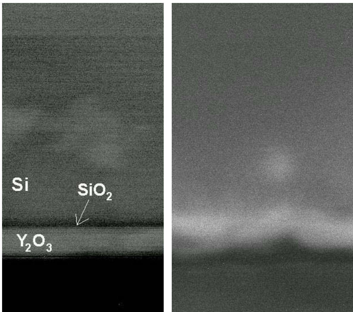
Obr.22: Struktura rozhraní deponované vrstvy a substrátu - vlevo před žíháním, vpravo po žíhání 5 minut při teplotě 1000°C
