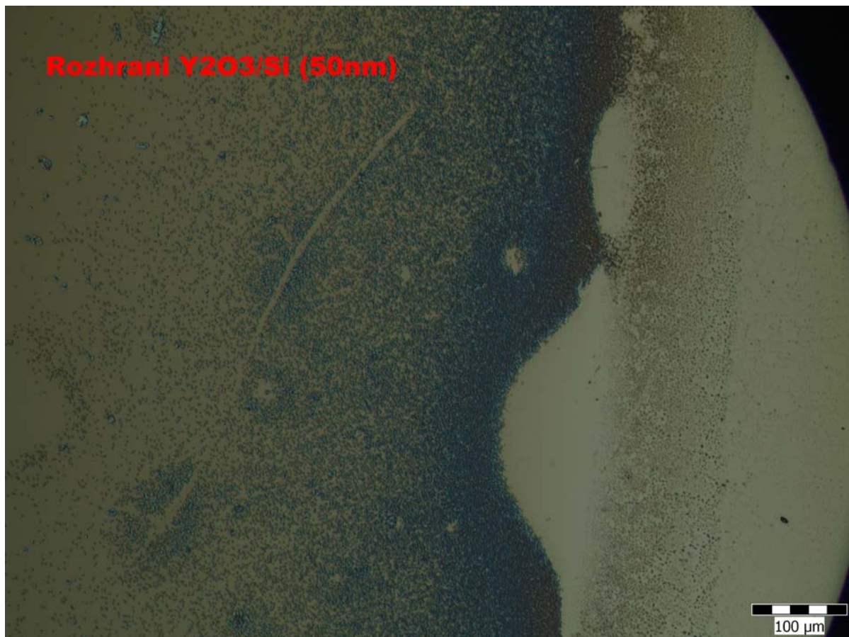
Obr.17: Snímek rozhraní 50nm vrstvy Y 2 O 3 a křemíku
