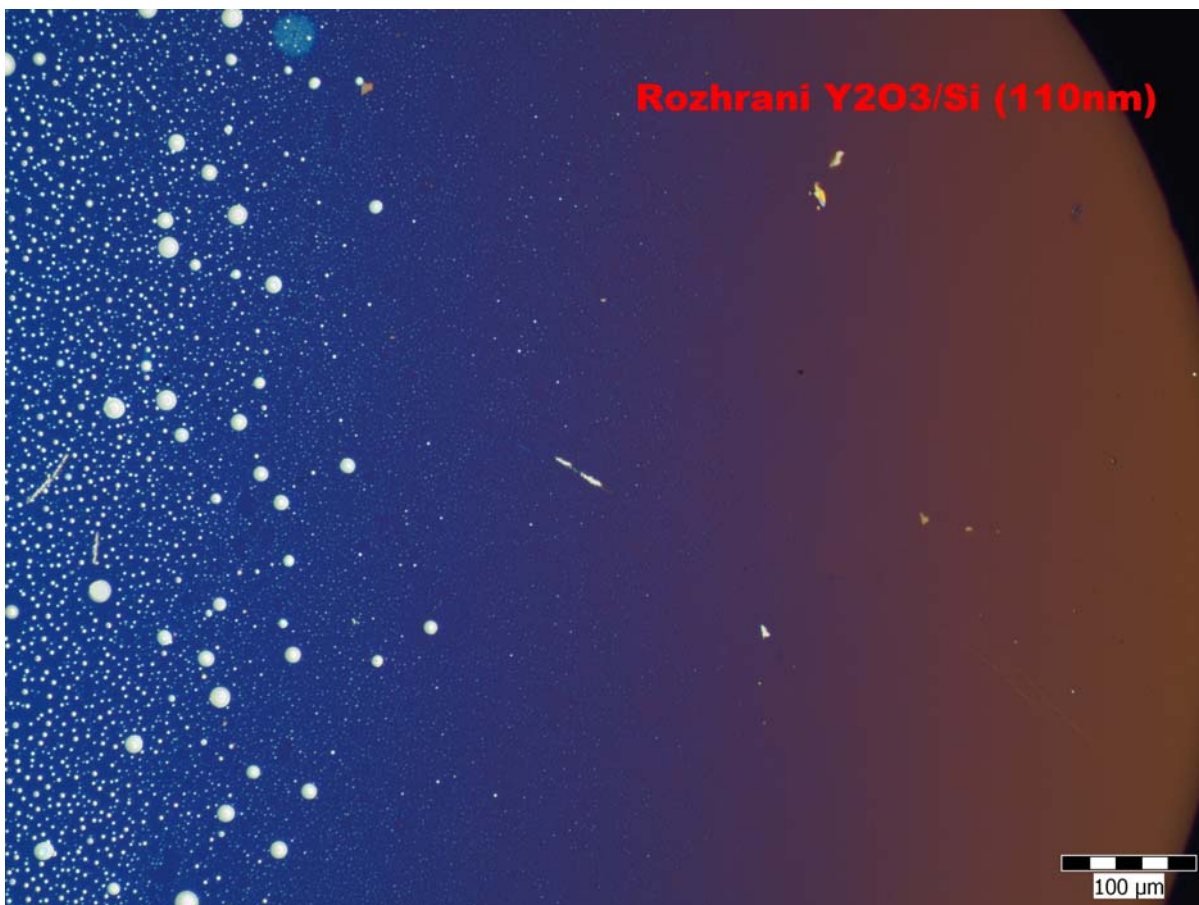
Obr.19: Snímek rozhraní 110nm vrstvy Y_2O_3 a křemíku
