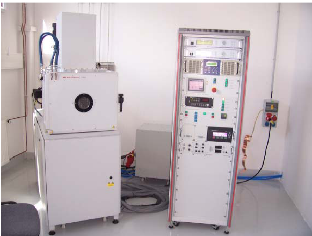
Obr.13: Fotografie naprašovacího systému TF600
