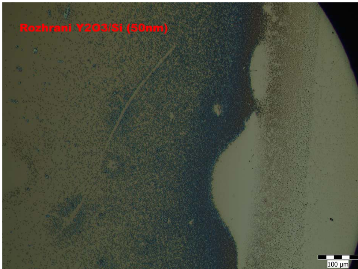
Obr.17: Snímek rozhraní 50nm vrstvy Y_2O_3 a křemíku
