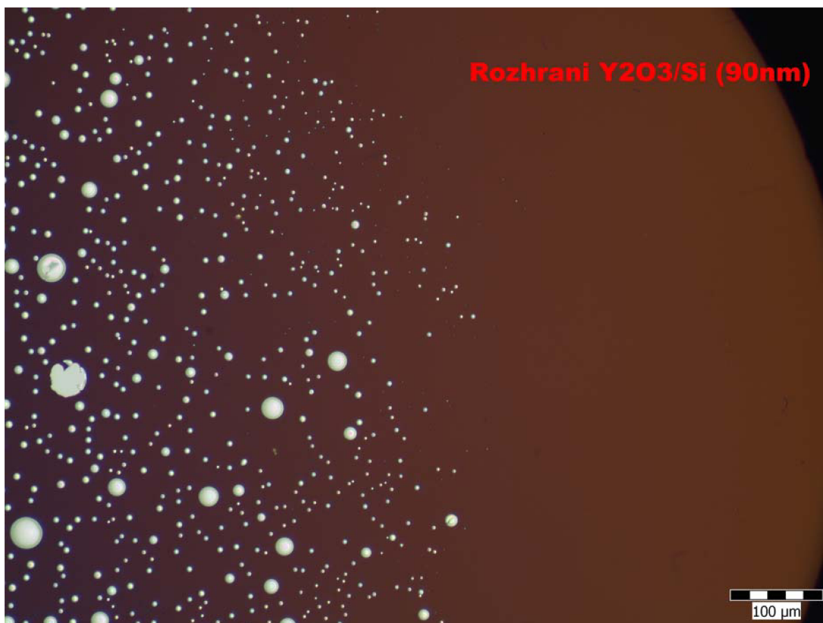
Obr.18: Snímek rozhraní 90nm vrstvy Y 2 O 3 a křemíku
