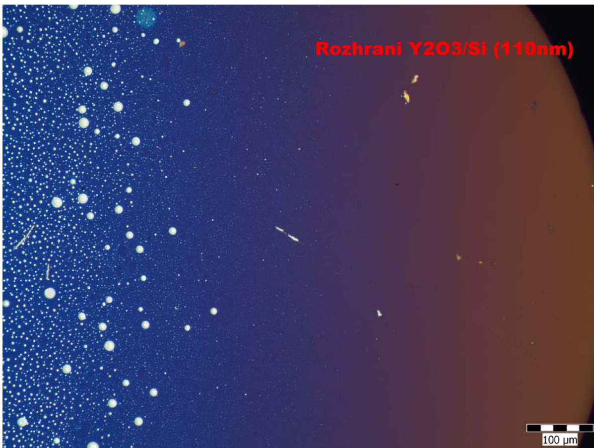
Obr.19: Snímek rozhraní 110nm vrstvy Y_2O_3 a křemíku
