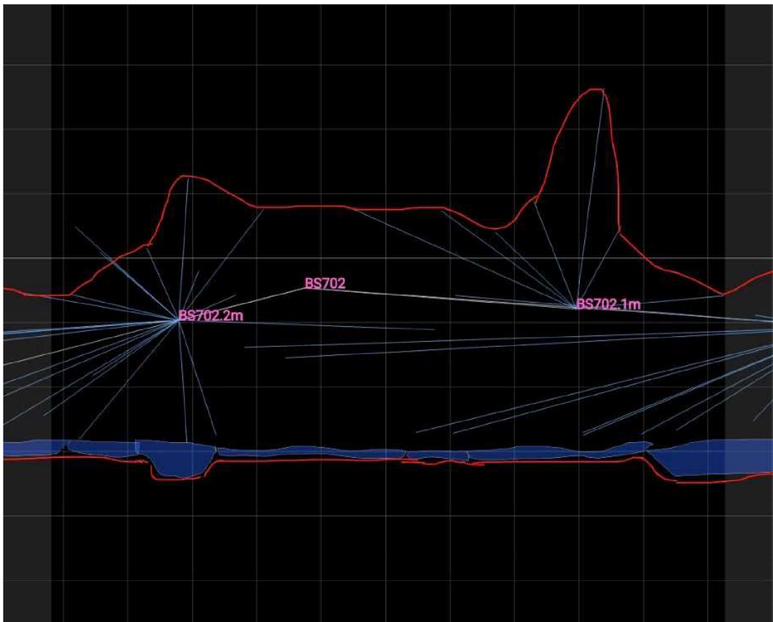
Obr. 4.7 - Náčrt rozvinutého podélného řezu
