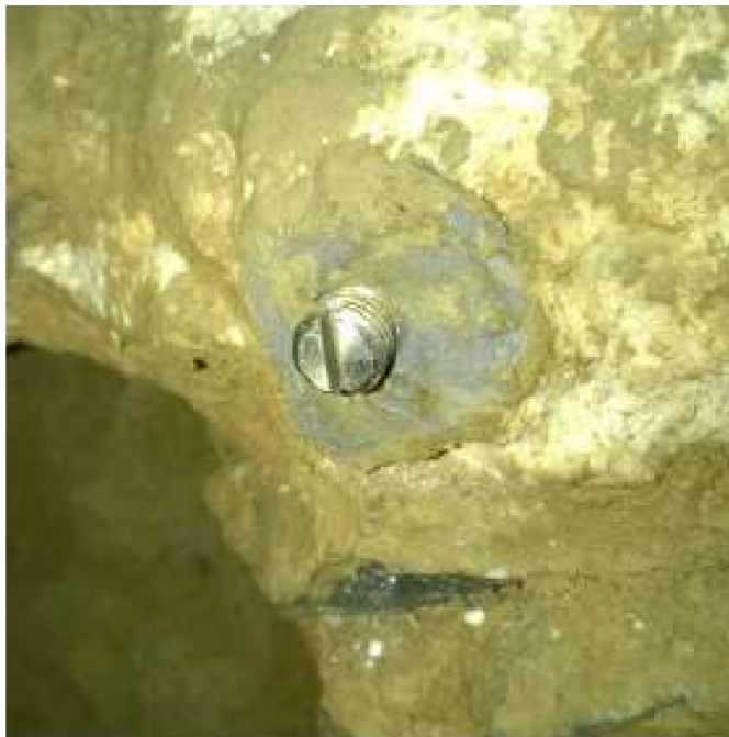
Obr. 3.3 - Ukázka stabilizace bodu měřické sítě [15]
