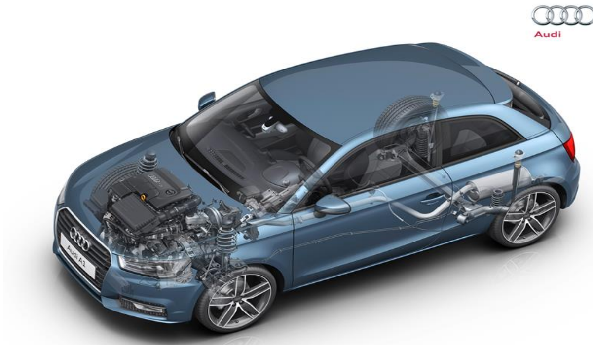
Obr. 4.10 – Vozidlo s předním pohonem, motor napříč [26]
