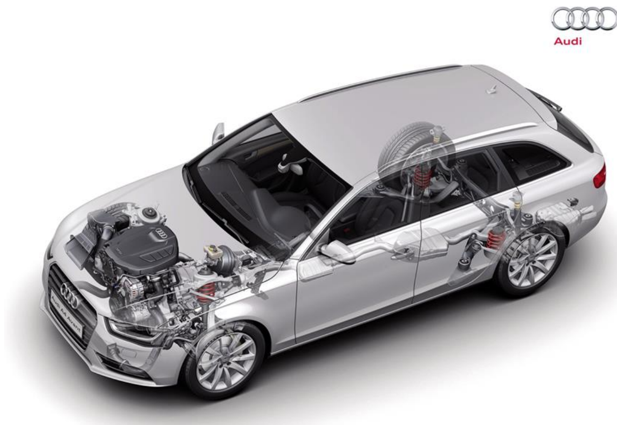
Obr. 4.9 – Vozidlo s předním pohonem, motor podél [25]
