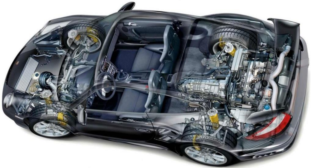
Obr. 4.7 – Vozidlo se zadním pohonem [23]
