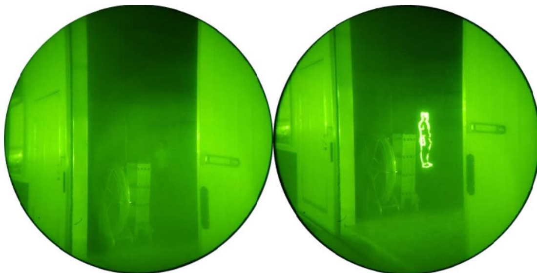
Obrázek 13 – Výstupu noktovizoru bez COTI (vlevo) a s COTI (vpravo) 48
