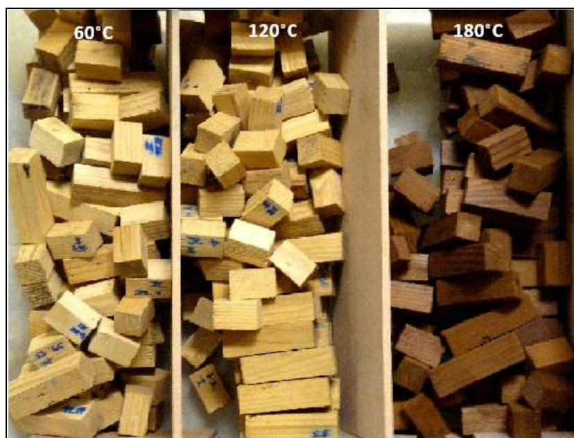
Obrázek 7.3: Vzorky dřeva po tepelném ošetření při 60°C, 120°C a 180°C.
