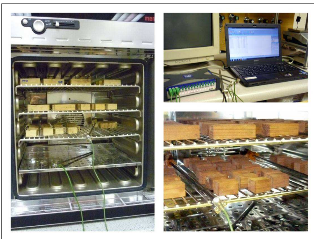
Obrázek 6.1: Termické namáhání v sušárně Memmert UNB 500 a soustava měřicí ústředny QUANTUM MX1609, elektrických termočlánků a PC se softwarem CatmanEasy.
