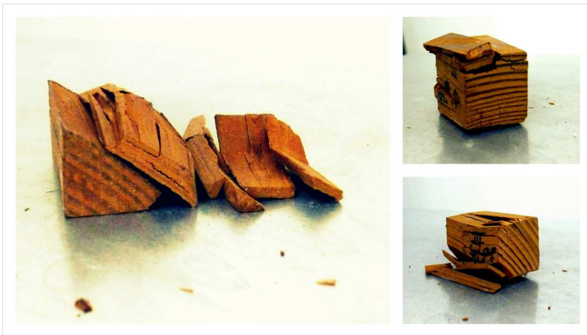
Obrázek 7.13: Charakteristické porušení vzorků ošetřených teplotou 180^\circ\text{C} při zkoušce pevnosti v tlaku ve směru vláken.
