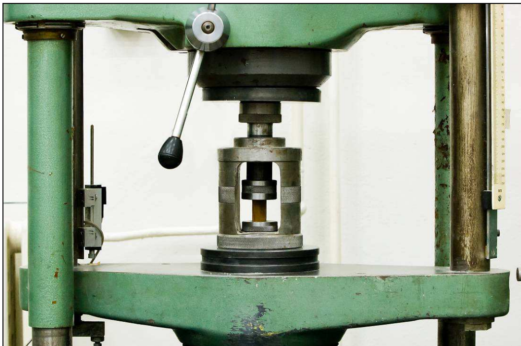
Obrázek 6.2: Zkoušení pevnosti v tlaku ve směru vláken.
