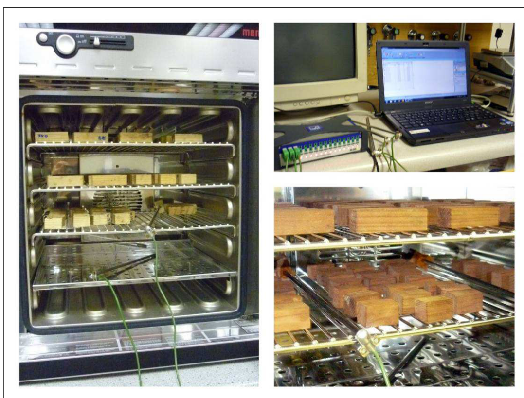
Obrázek 6.1: Termické namáhání v sušárně Memmert UNB 500 a soustava měřící ústředny QUANTUM MX1609, elektrických termočlánků a PC se softwarem CatmanEasy.
