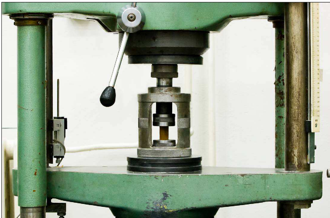
Obrázek 6.2: Zkoušení pevnosti v tlaku ve směru vláken.
