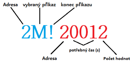
Obrázek 11: Rozbor odpovědi čidla na příkaz aM! v textové podobě
