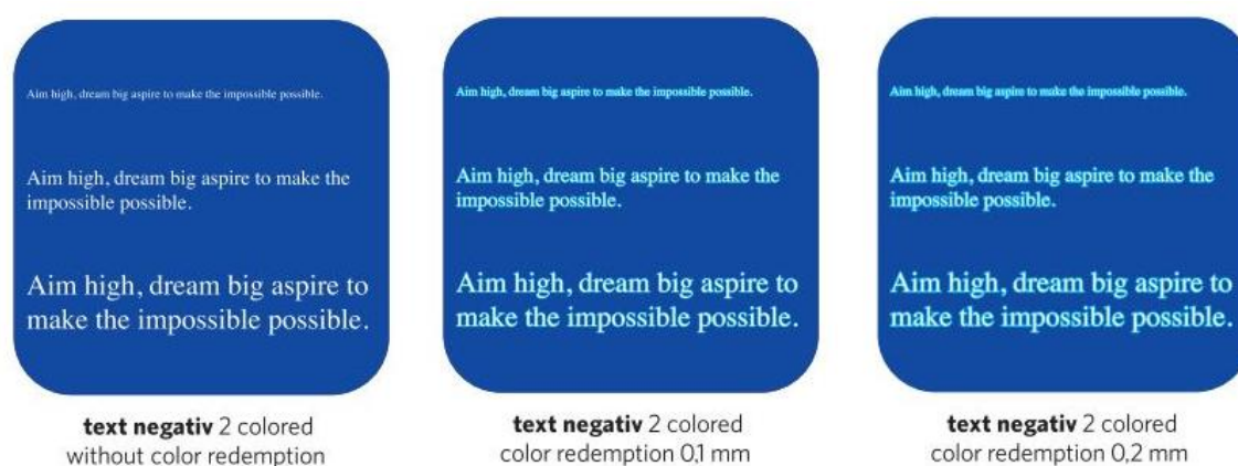
Obr. 6.4: Ukázka přesahů u textu ze způsobilostního testu Zdroj: interní data společnosti Amcor Flexibles.
