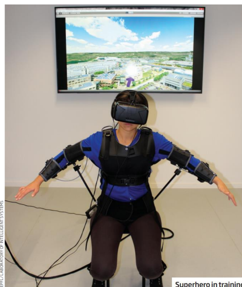
Obrázek 6: VR postroj k ovládání dronů
