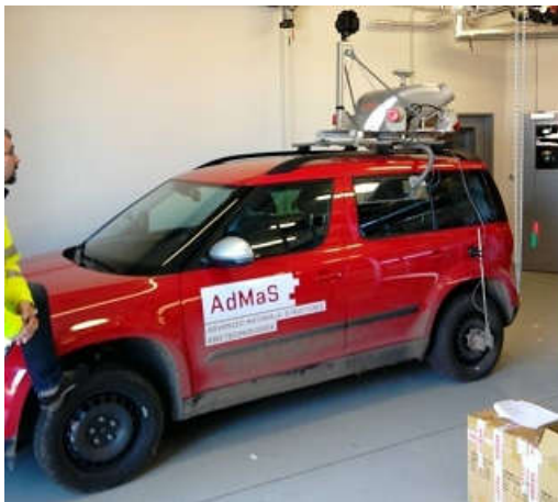
Obr. 8 Automobil vybavený laserovým skenovacím systémom Riegl VMX-450
