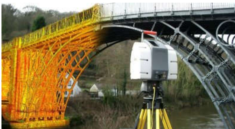
Obr. 4 Princíp statického laserového skenovania [14]
