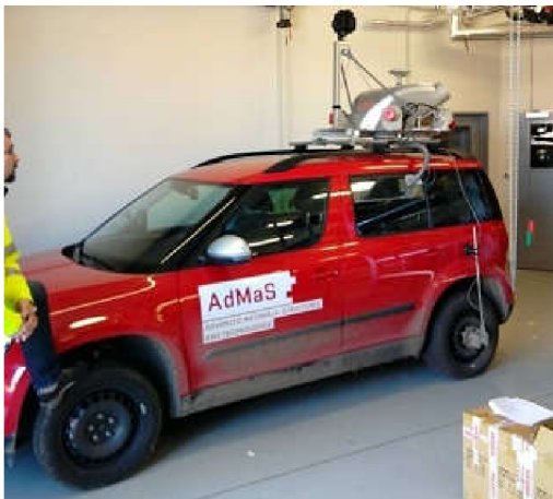
Obr. 8 Automobil vybavený laserovým skenovacím systémom Riegl VMX-450
