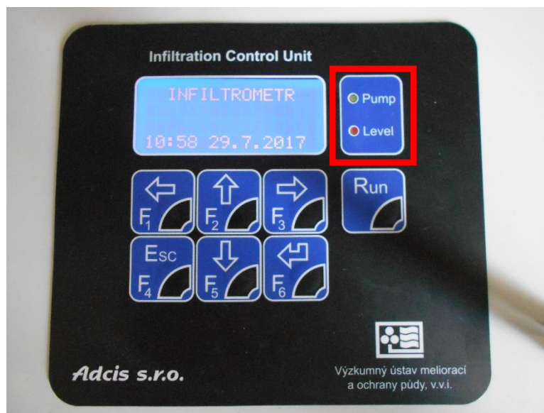
Obrázek č. 2 : LED světla na kontrolní jednotce.
