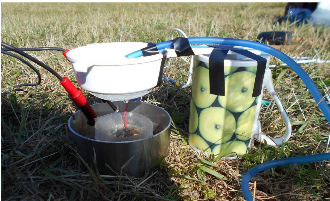
Obrázek č. 11: Instalace infiltrometru v terénu.
