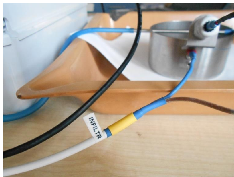
Obrázek č. 4 : Kabel INFILTROMETR, sloužící k simulaci deště.
