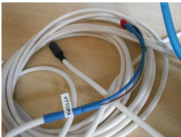
Obrázek č. 5: Kabel VÝTOPA, sloužící k měření skutečného deště.
