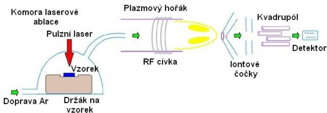
Obrázek 5: Schéma možného uspořádání hmotnostního spektrometru s laserovou ablací [27]
