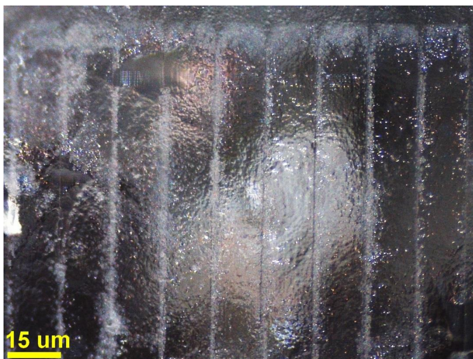
Obrázek 51: Snímek linie laseru (celkový rozměr linie 150 \mu\text{m} ) na vzorku 6b pod optickým mikroskopem (LCD MIKRO 5MP, BRESSER) se čtyřnásobným přiblížením
