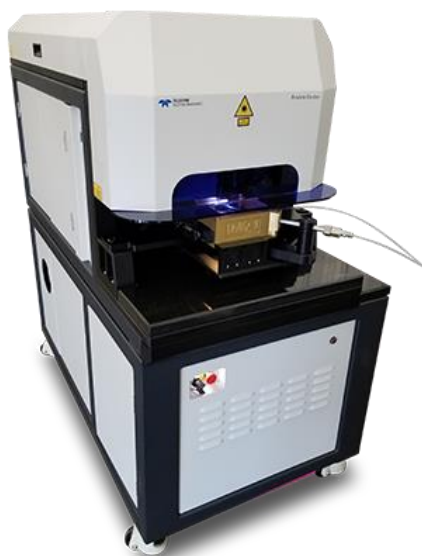
Obrázek 20: Laserový ablační systém Teledyne, Photon Machine – Analyte Excite + [38]
