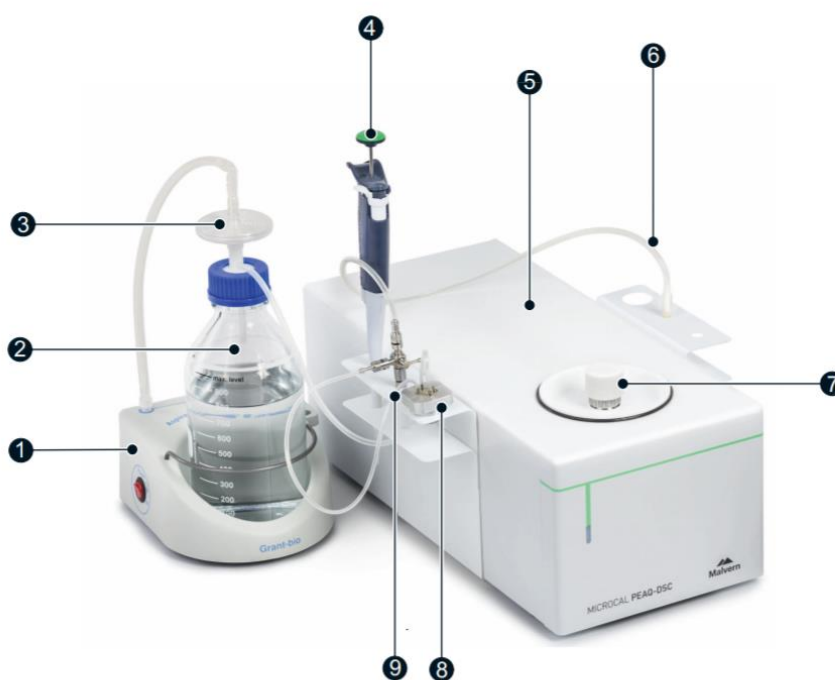
Obrázek 10: DSC kalorimetr MicroCal PEAQ-DSC, kde 1 – aspirátor, 2 – láhev na odpad, 3 – filtr aspirátoru, 4 – pipeta 250 µl, 5 – jednotka celý PEAQ-DSC, 6 – vakuový aspirátor, 7 – víčko uzavírající celý, 8 – nástroj pro ruční čištění, 9 - kohoutek [36]
