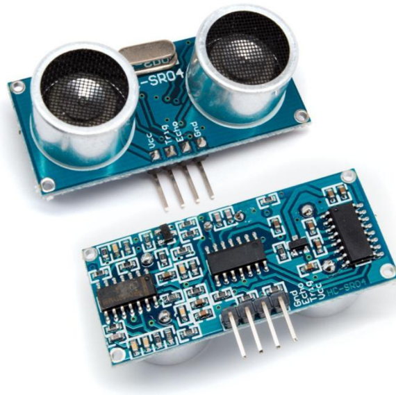
Obr 6 - HC-SR04 ultrazvukový senzor[7]
