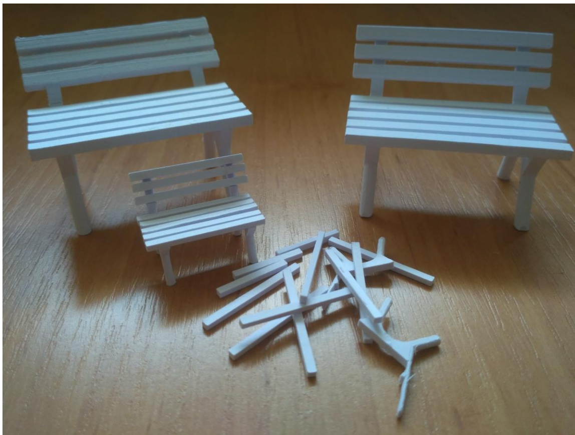
Obr.: 20 – Finální výsledek všech tří laviček. Vlevo lavička tištěná na nohou, vpravo lavička tištěná na zádech a v popředí jedna slepená lavička a díly na další lavičku
