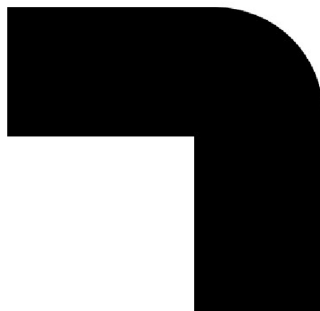
Obrázek 5.4: Vykreslení rohu pro případ, kdy je šířka hrany větší než hodnota zaoblení pro daný roh (příklad je z prohlížeče Chrome).
