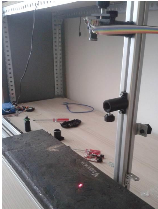
Obrázek 5-3 – Testování senzoru ADNS-3080 s čočkou o ohniskové vzdálenosti 4,2 mm
