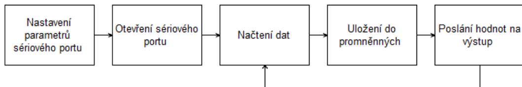
Obrázek 3-7 – Blokové schéma skriptu nacitani.m
