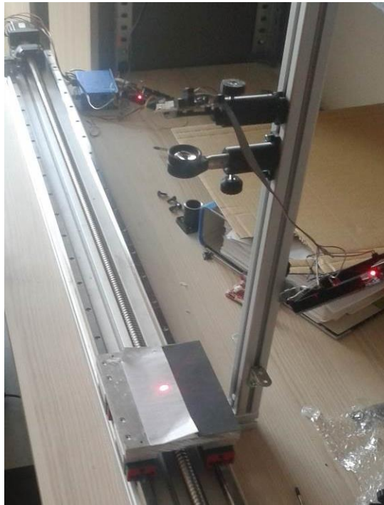
Obrázek 5-1 – Testování čočky s ohniskovou vzdáleností 35 mm
