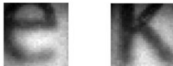
Obrázek 3-10 – Obrázky získané senzorem ADNS-9800
