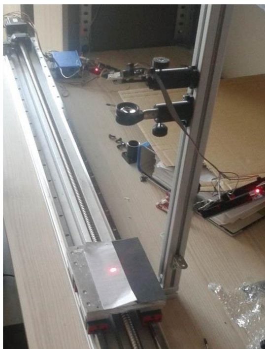
Obrázek 5-1 – Testování čočky s ohniskovou vzdáleností 35 mm
