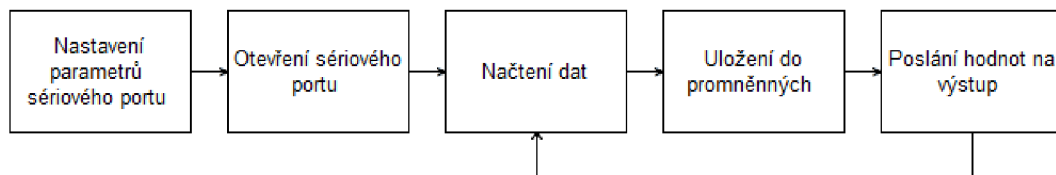
Obrázek 3-7 – Blokové schéma skriptu nacitani.m
