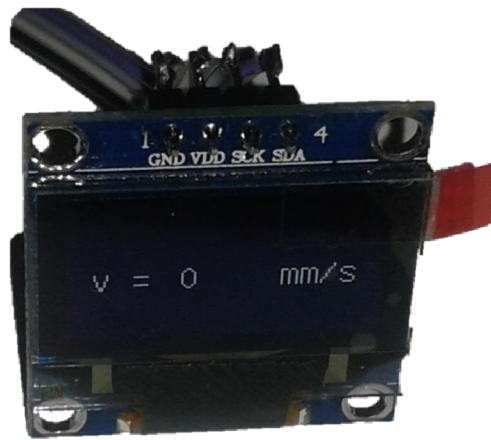
Obrázek 6-6 – Použitý OLED displej
