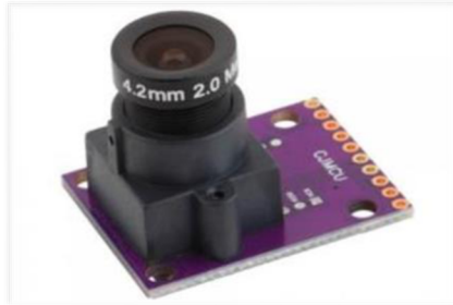
Obrázek 2-2 – ADNS-3080 s optickou soustavou
