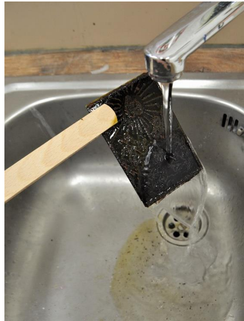
Obr. 97: omytí matrice pod studenou vodou
