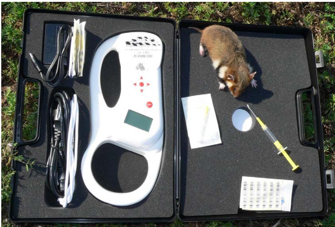
Obr. 5 Zařízení pro rozpoznání čipů (vlevo) a injekční aplikátor pro jejich zavádění (vpravo)
