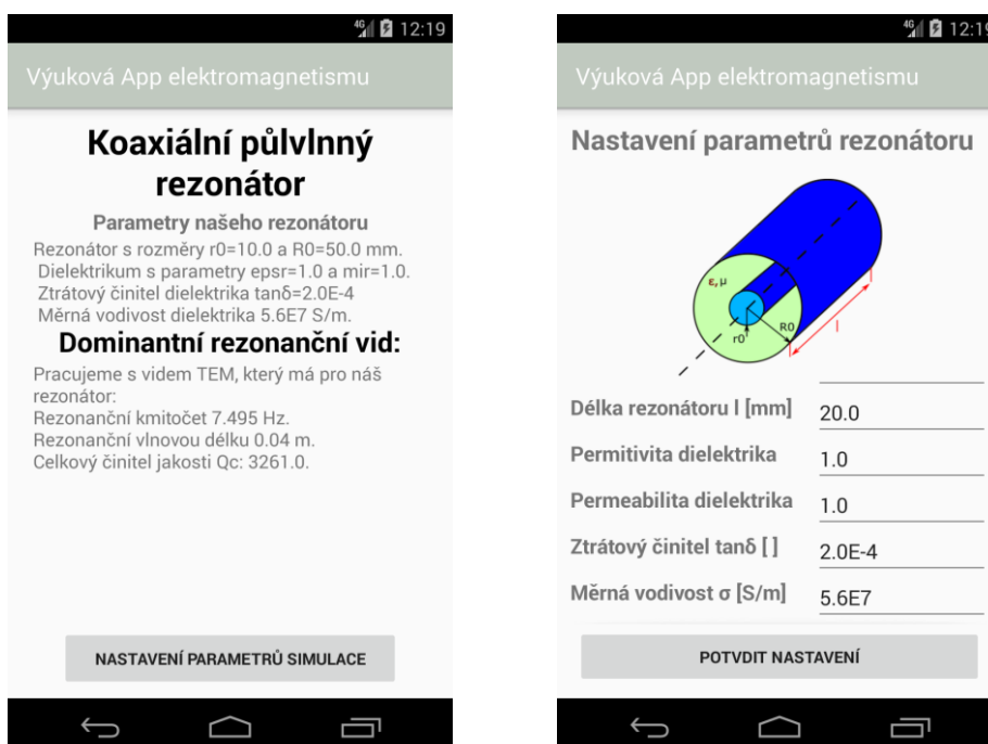
Obr. A25 Obrazovka s rezonančními vidy rezonátoru (vlevo) a nastavením parametrů rezonátoru (vpravo)
