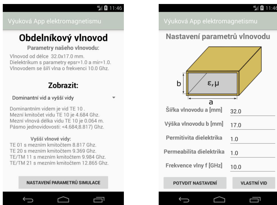
Obr. A18 Obrazovka s vidy, které se ve vlnovodu šíří (vlevo) a nastavením parametrů vlnovodu (vpravo)
