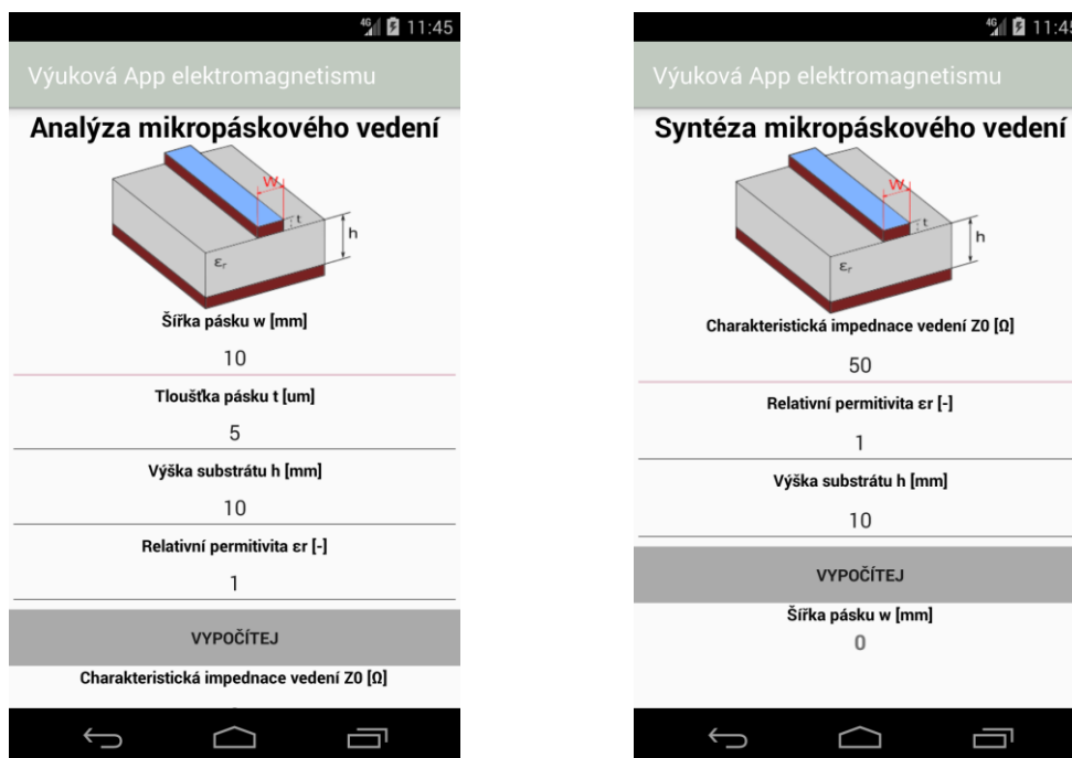
Obr. A16 Obrazovky zobrazující analýzu mikropáskového vedení (vlevo) a syntézu mikropáskového vedení (vpravo)
