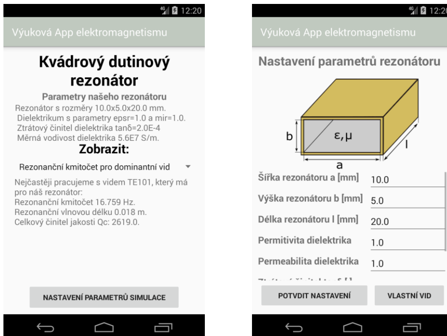
Obr. 5.11 UI aktivity WaveResCavityCuboid . Zleva můžeme vidět fragmenty: WaveResCavityCuboidSim a WaveResCavityCuboidSet
