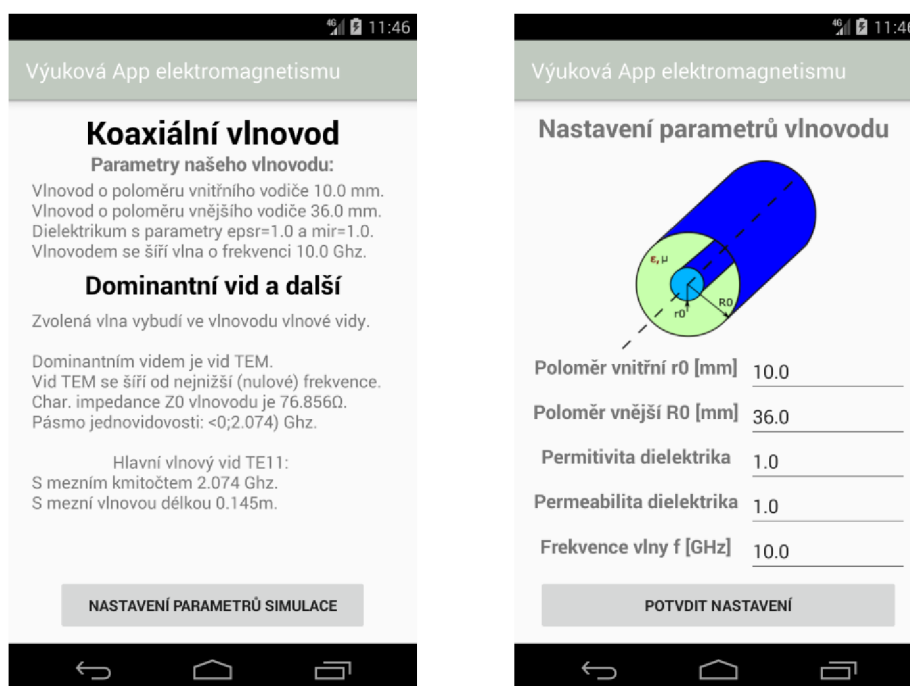
Obr. A20 Obrazovka s vlny, které se ve vlnovodu šíří (vlevo) a nastavením parametrů vlnovodu (vpravo)
