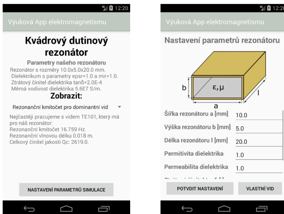
Obr. A23 Obrazovka s rezonančními vidy rezonátoru (vlevo) a nastavením parametrů rezonátoru (vpravo)
