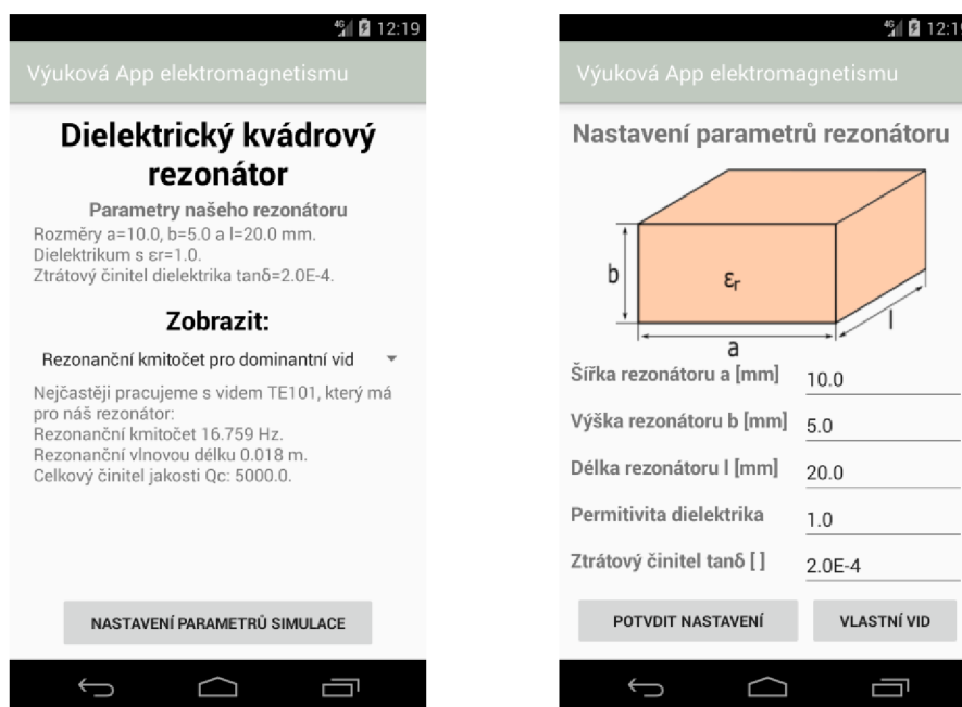
Obr. A26 Obrazovka s rezonančními vidy rezonátoru (vlevo) a nastavením parametrů rezonátoru (vpravo)
