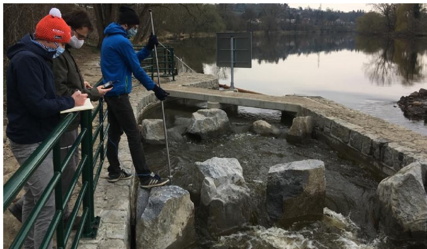
Obrázek č. 18: Měření bodových rychlostí proudu ve štěrbině RP I v druhé balvanité linii.
