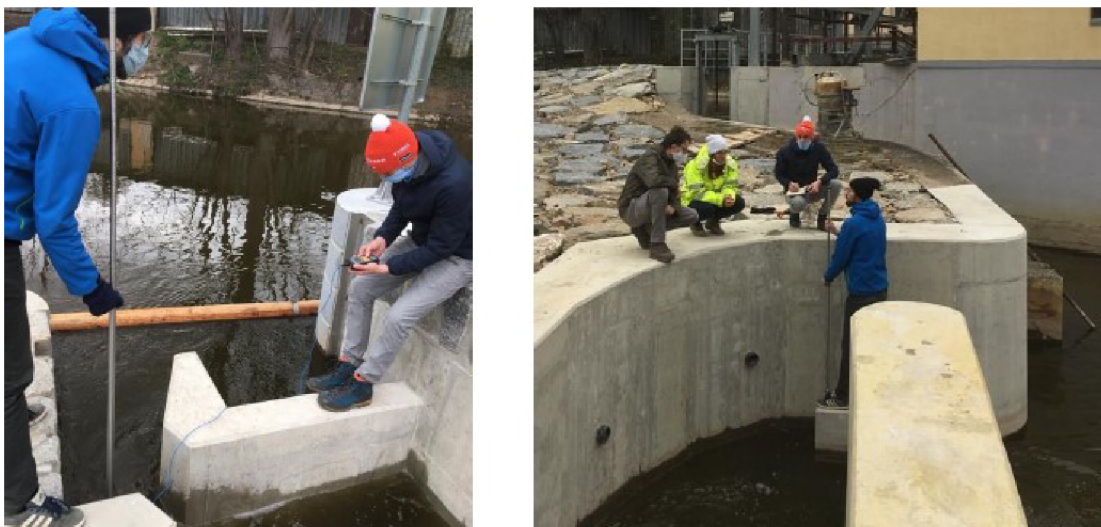
Zdroj: Zpráva ze zaměření hladin na rybích přechodech RP I a RP II a měření rychlostí v proudu ve vybraných štěrbinách (3. 4. 2020, Ing. David Bůžek)
