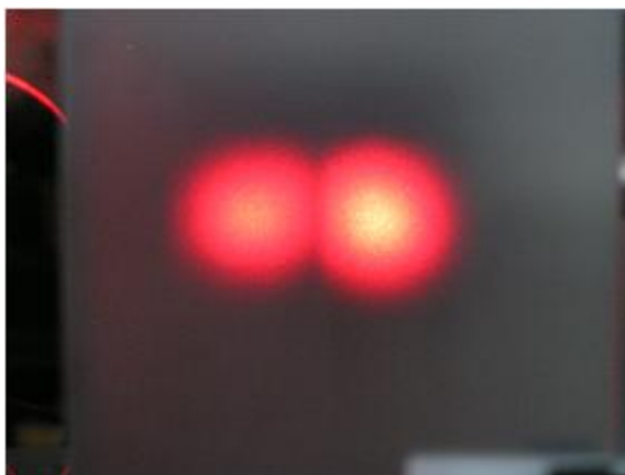
Obr. 30: Výstupní módy LP 01 za Wollastonovým polarizátorem [20]
