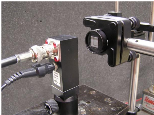
Obr. 28: Wollastonův hranol a PIN dioda[18]
