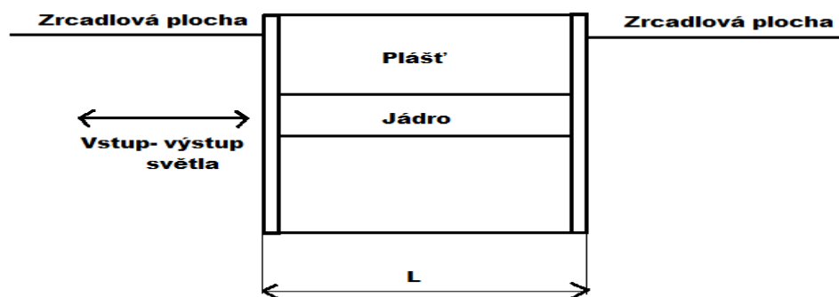
Obr. 16 : Konstrukce senzoru s Fabry - Perotovým rezonátorem [6]
