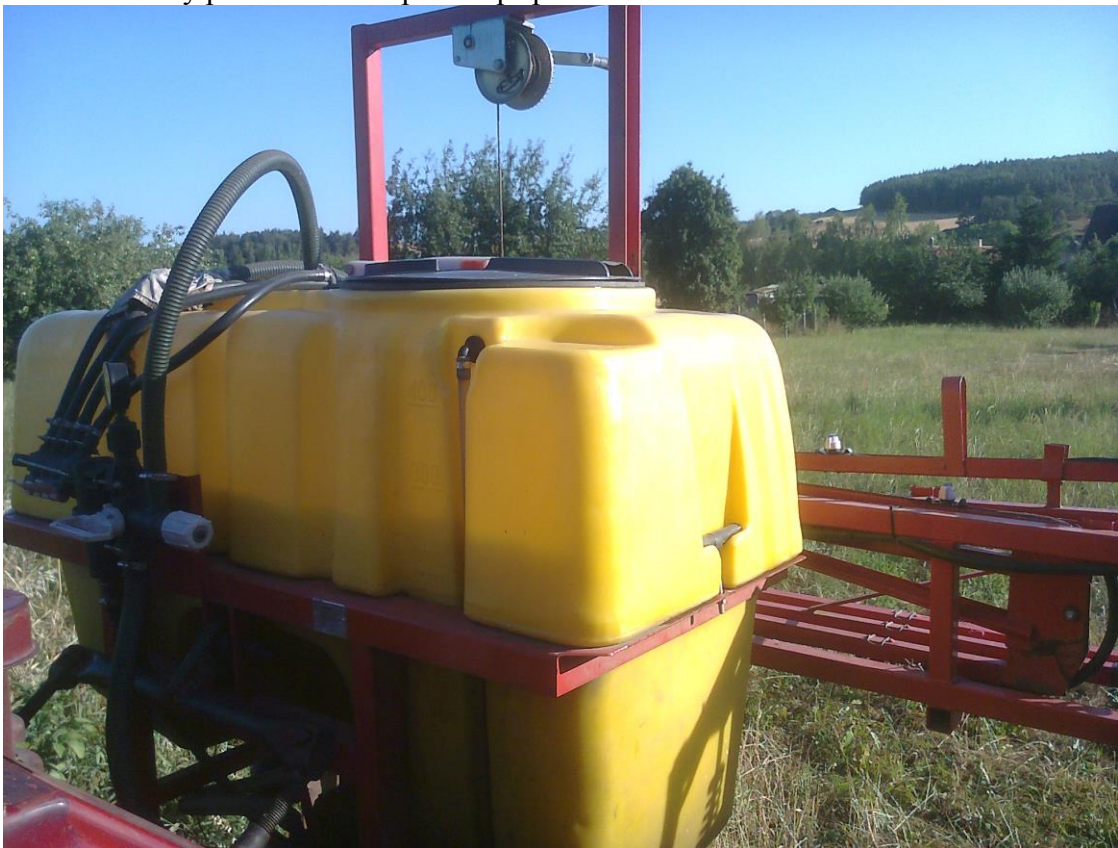
Obr. 7: Nesený postřikovač k aplikaci přípravků
