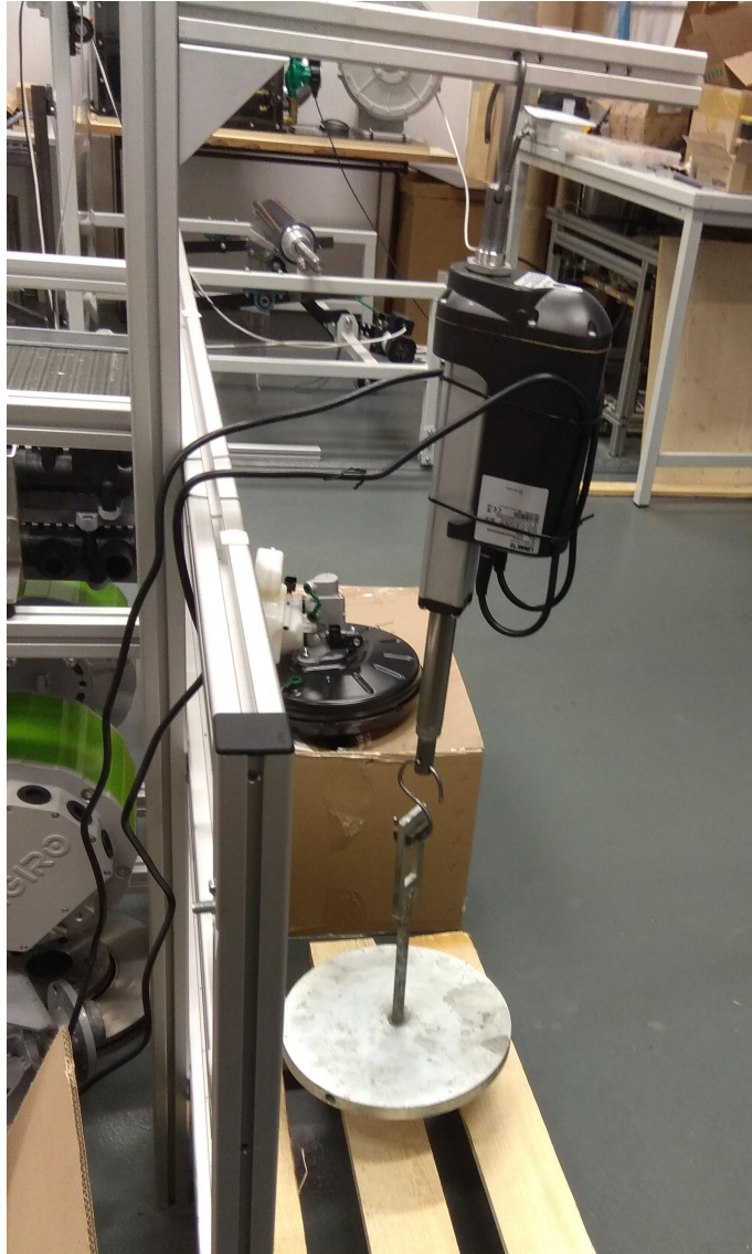
Obrázek 9.3: Testovací rám pohonu LA36 (zdroj autor)
