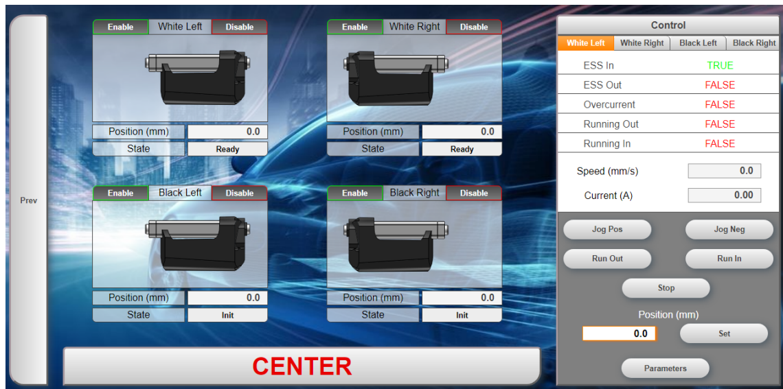
Obrázek A.5: Zobrazení zasunutého pohonu LA36 ve vizualizaci (zdroj autor)
