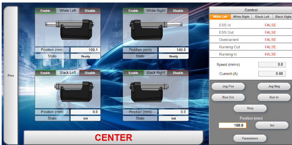
Obrázek A.6: Zobrazení vysunutého pohonu LA36 ve vizualizaci (zdroj autor)
