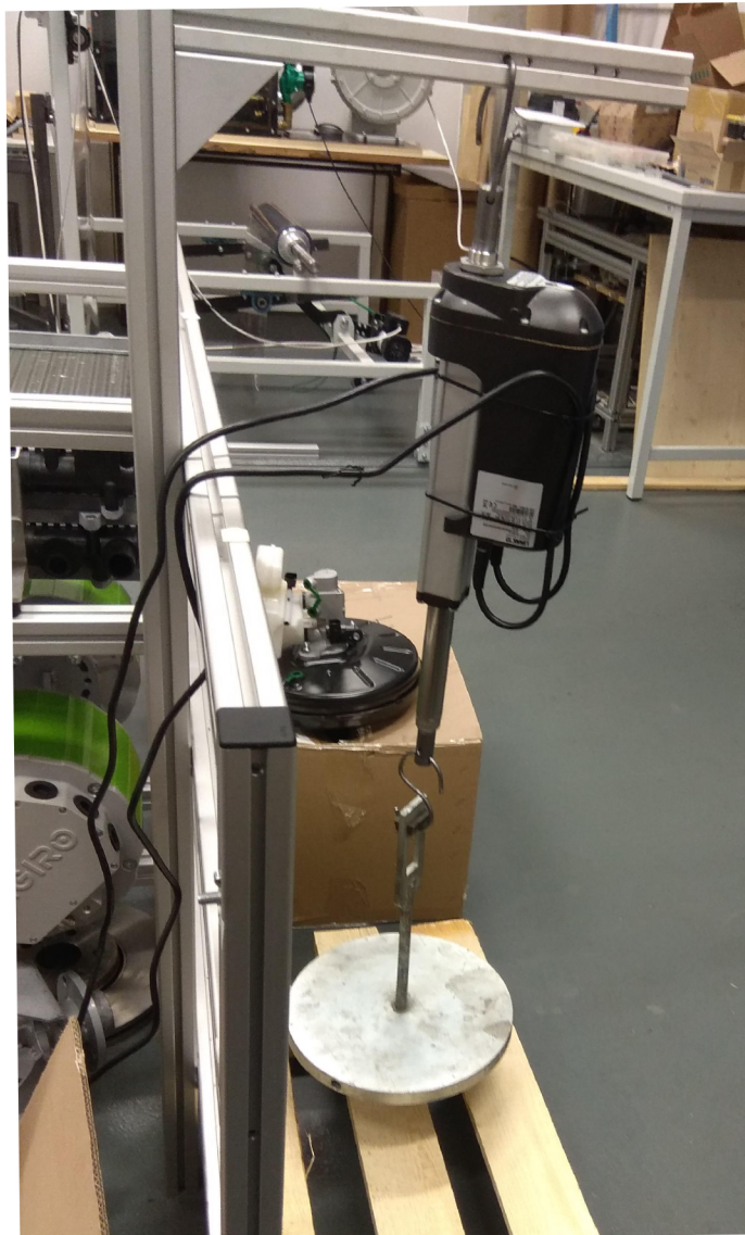
Obrázek 9.3: Testovací rám pohonu LA36 (zdroj autor)
