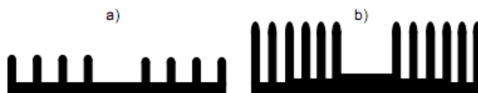
Obr. 29 Profily chladičů – a) přírozené chlazení, b) nucené chlazení
