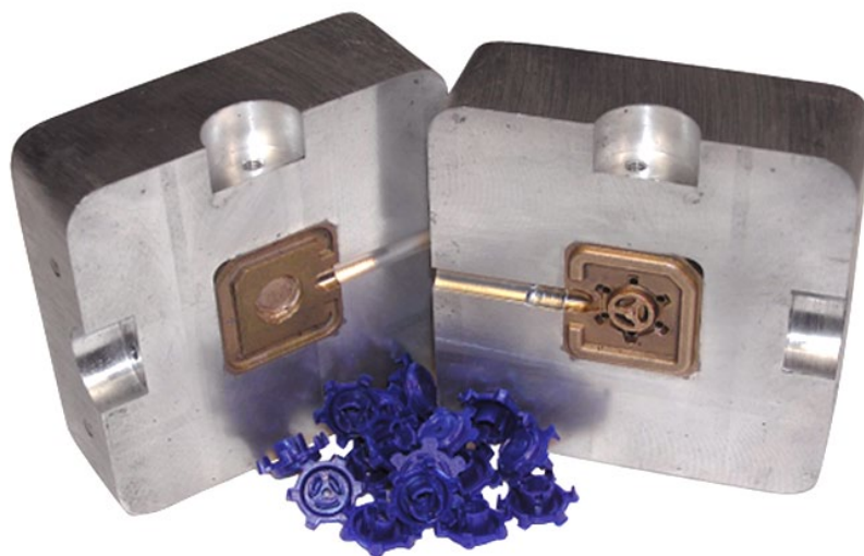
Obr. 2.8 Vstříkovací forma vyrobená pomocí hybridní koncepce. 26
