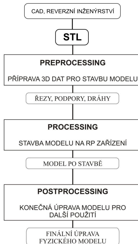
Obr. 1.2 Schéma procesu výroby prototypu technologií RP. 4
