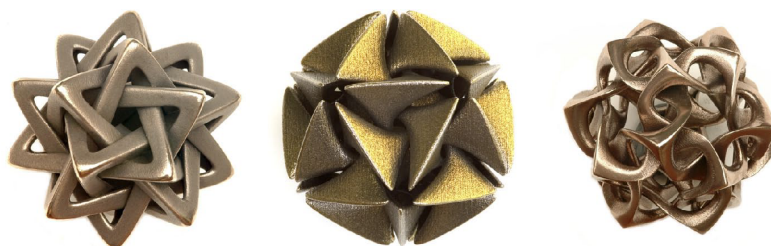
Obr. 2.3 Ozdobné přívěšky vyrobené metodou DMLS. 20
