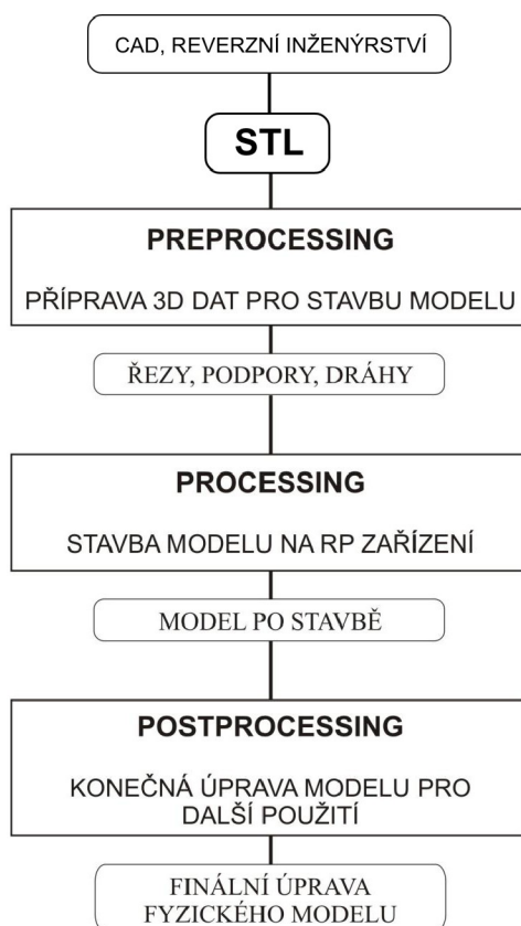
Obr. 1.2 Schéma procesu výroby prototypu technologií RP. 4
