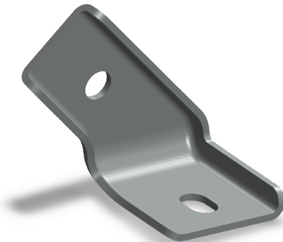
Obr. 3.3 Model prototypu 03 vyrobený metodou DMLS.
