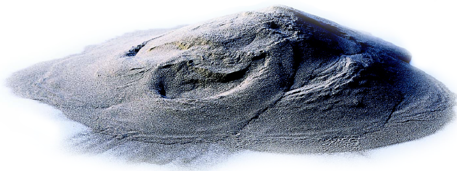
Obr. 2.4 Nerezová ocel (GP1) ve formě prášku. 21
