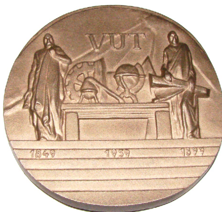
Obr. 2.7 Prototypový model VUT medaile vyrobený metodou DMLS. 25
