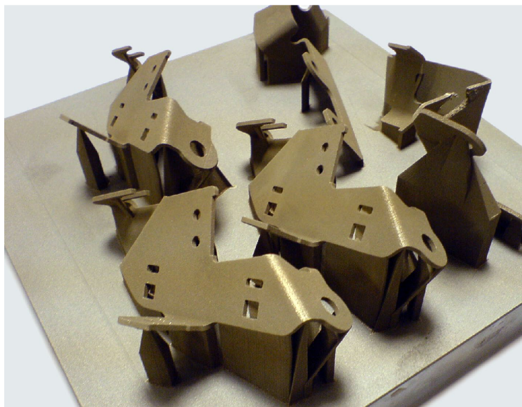
Obr. 3.8 Vyrobené součásti spojené s platformou podpůrnými prvky.
