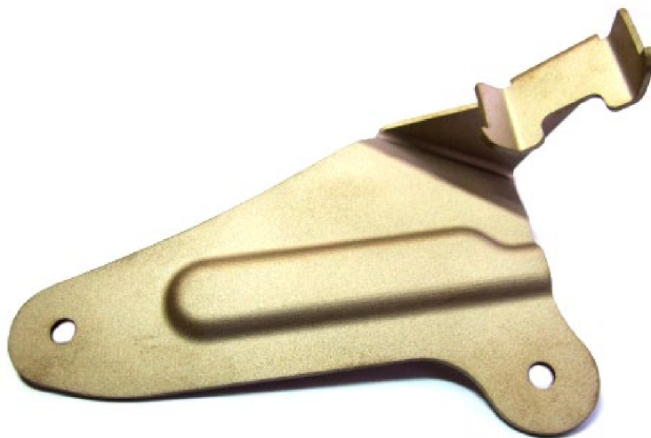
Obr. 3.9 Vyrobená prototypová součást metodou DMLS.
