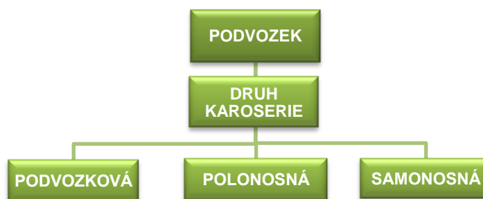
Obr. 1 Druhy karosérii podle vztahu k podvozku
