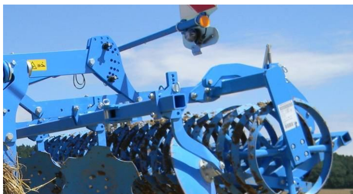
Obrázek 7: Systém nastavení pracovní hloubky
