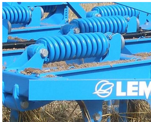
Obrázek 6: Horizontální dvoupružinový systém jištění
