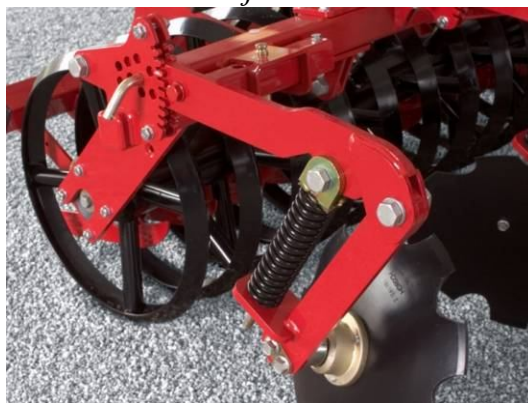
Obrázek 9: Pružinové jištění urovnávacích talířů
