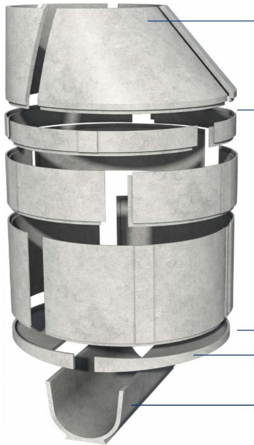
Obr. 5.5.2 2 Systém sanace šachet polymer betonem [25]
