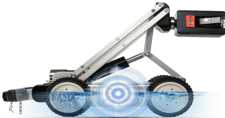
Obr. 4.2.1 2 Robot na detekci infiltrace balastních vod [6]
