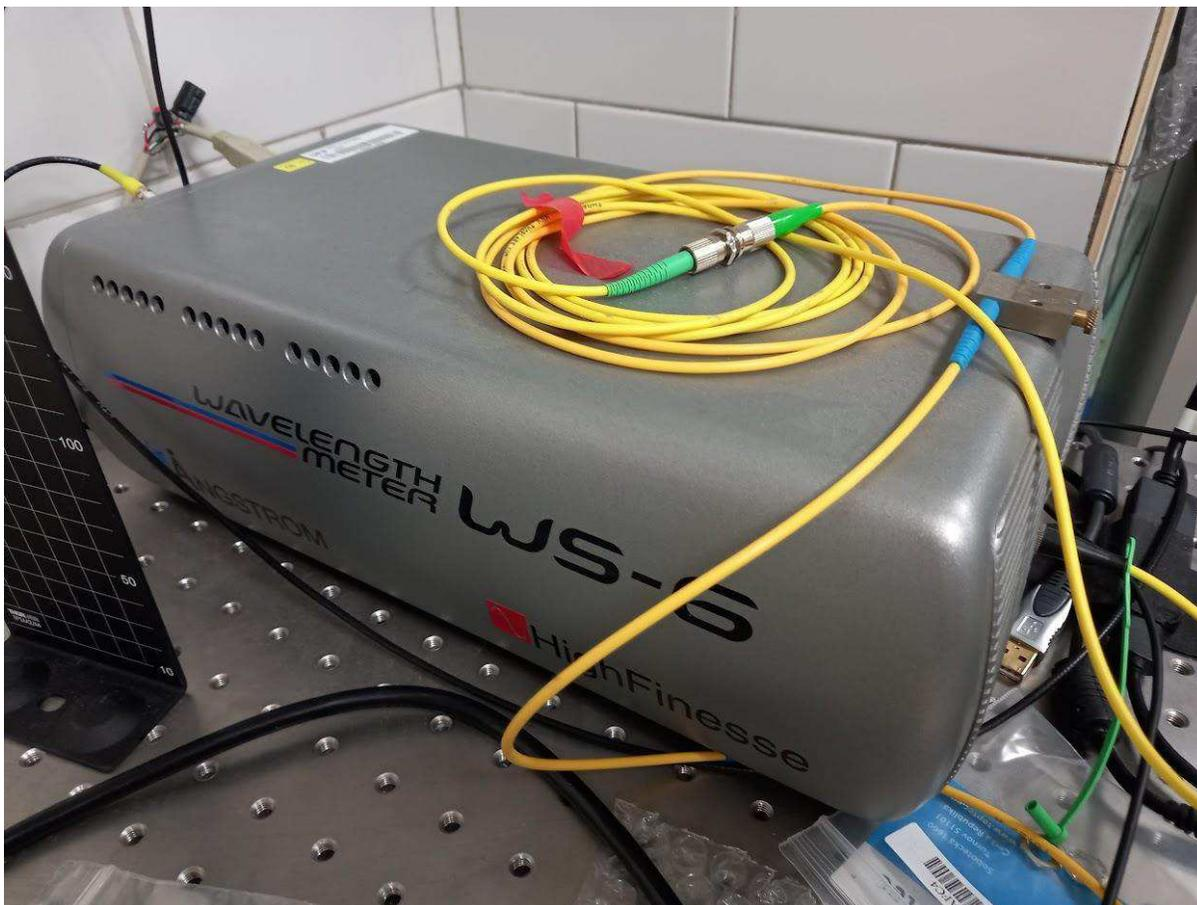
Obrázek 28 Vlnoměr WS-6 HighFinesse
