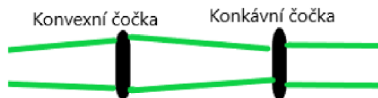
Obrázek 19 - Kolimátor (konvexní a konkávní čočka)
