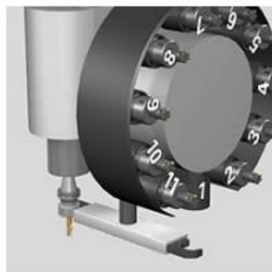
Obr. 26 Výměna pomocí manipulátoru [8]
