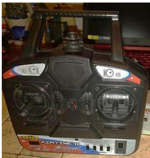
Obr.11: 4-osý ovládač s Arduino rozhraním pre komunikáciu s PC [7]
